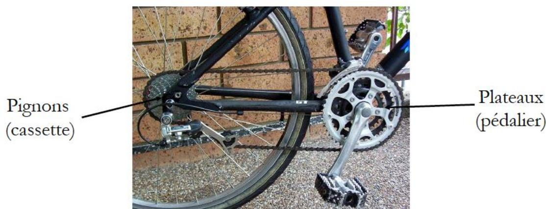
Fig.1 : Système de transmission d'un vélo
